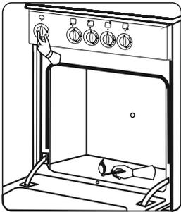
Зажигание основной горелки духовки производится следующим образом:
